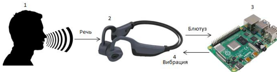
Рис. 1. Схема работы системы перевода звучащей речи в азбуку Морзе через вибрации
