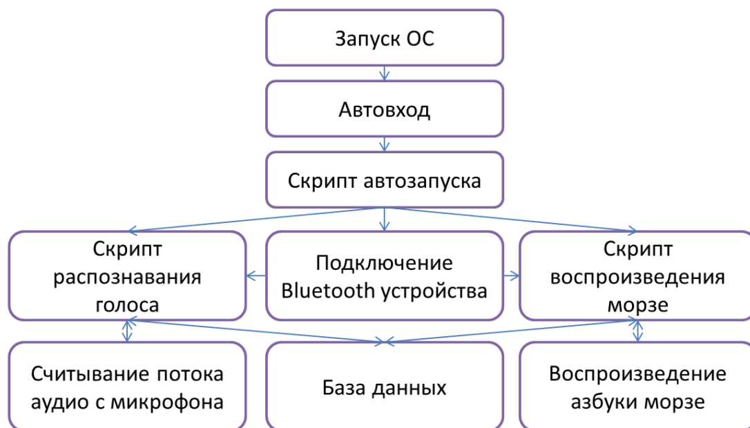
Рис. 9. Принцип работы приложения «Виброслух»
