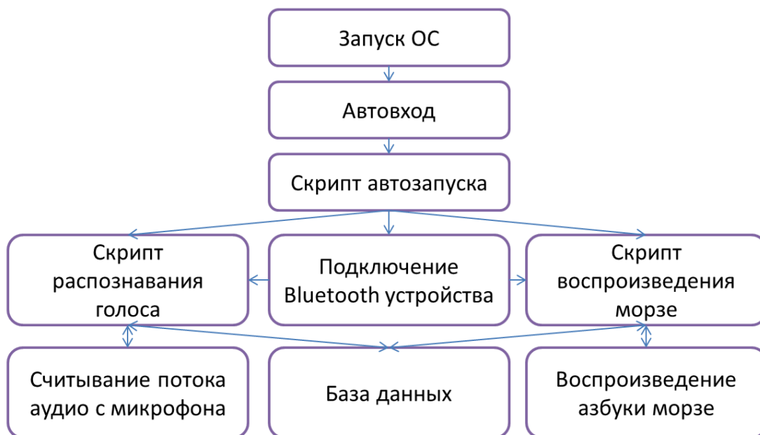
Рис. 9. Принцип работы приложения «Виброслух»
